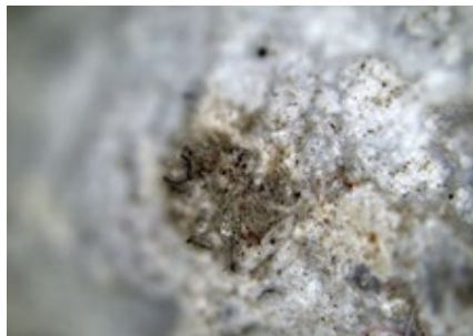
Рисунок 7. Микрофотографии поверхности титановой губки, подверженной коррозионному воздействию ( \times 150 )
