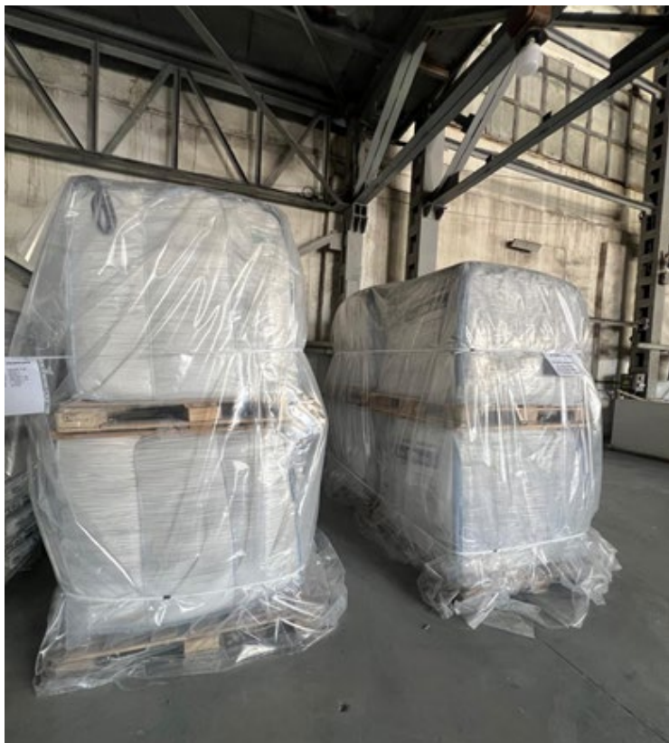
Рисунок 2. Контейнеры биг-бэг весом 1 т в штабеле в 2 яруса по высоте
