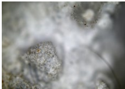
Рисунок 7. Микрофотографии поверхности титановой губки, подверженной коррозионному воздействию ( \times 150 )
