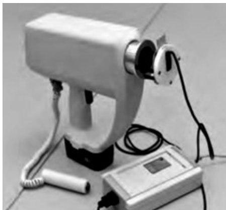
Рисунок 11. Портативный аппаратно-программный комплекс для рентгенографии семян
